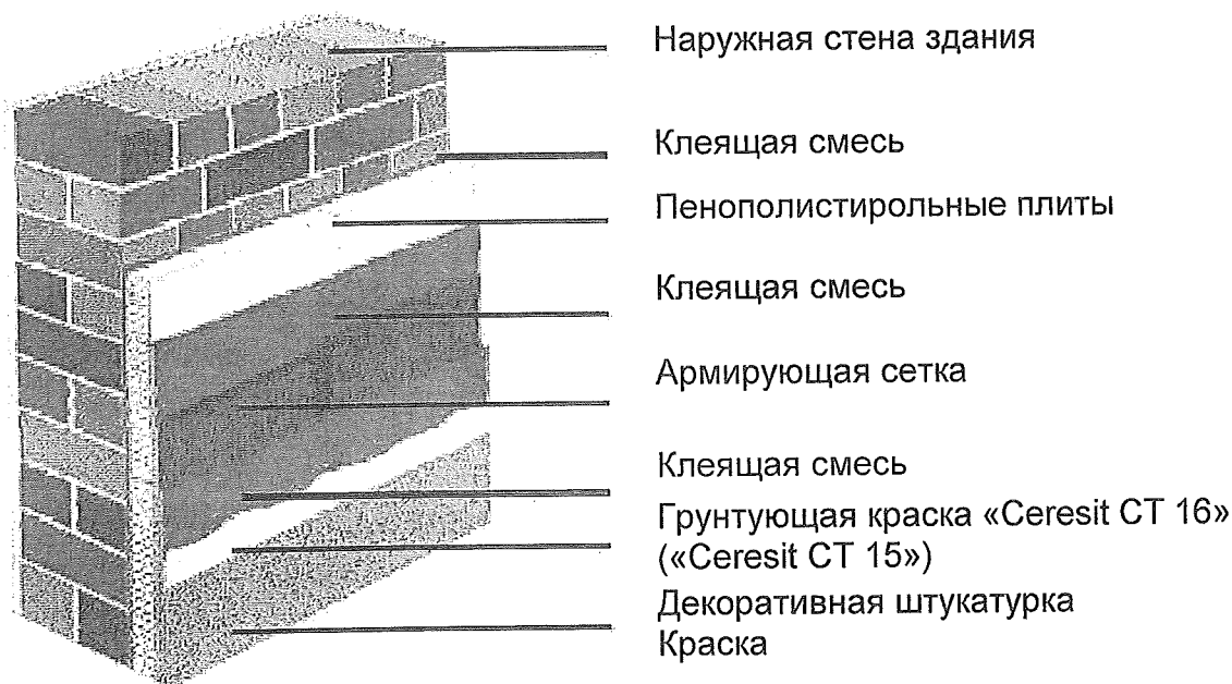
Рисунок 2 - Система тепловой изоляции «Ceresit VWS»
